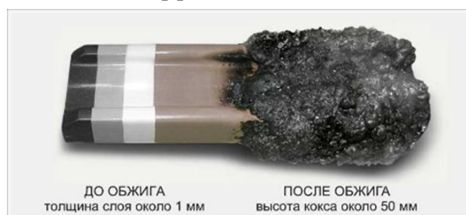
Рис. 1. Испытание огнезащитного средства для металла
