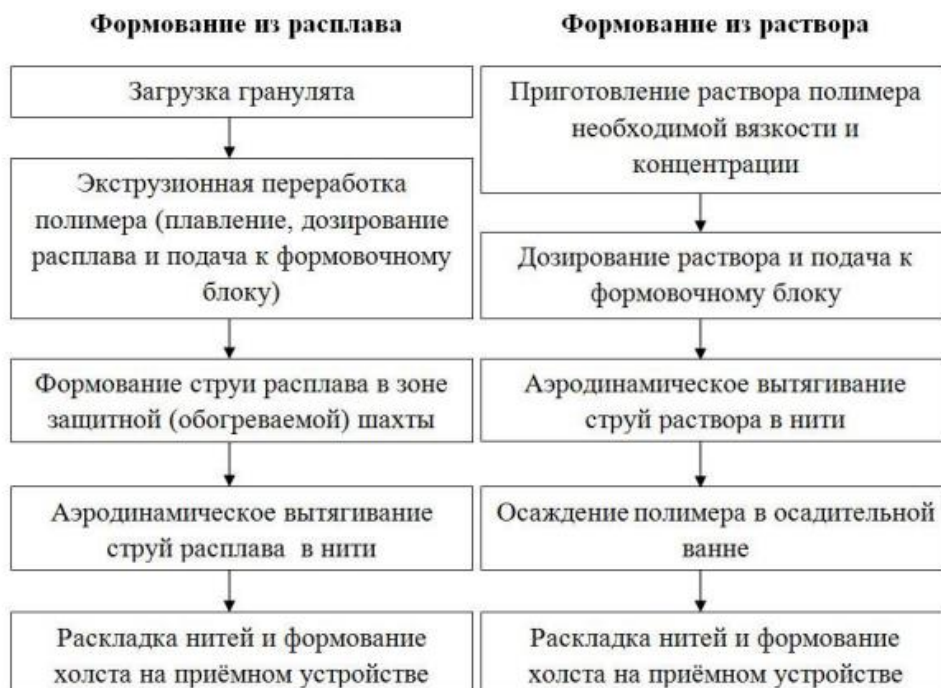
Рис. 1. Принципиальная схема способа аэродинамического формования из полимерных расплавов и растворов
