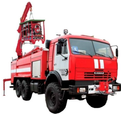
Рис. 4. Пожарно-спасательный автомобиль с роботизированными мобильными установками для тушения нефтеналивных резервуаров (РСА РМУТНР)
