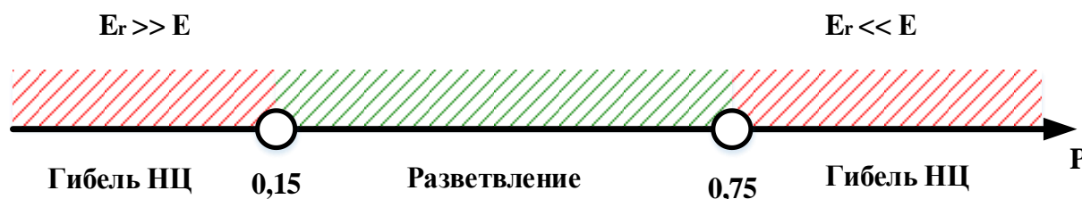
Рис. 1. Интервальная схема разветвленно-цепного процесса горения предельных углеводородов
