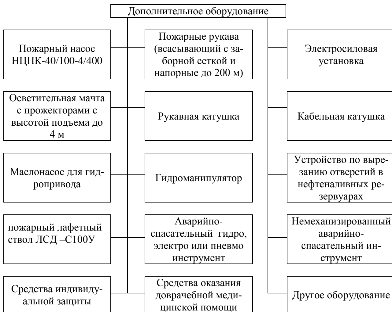
Рис. 5. Принципиальная схема комплектации оборудованием пожарно-спасательного автомобиля
