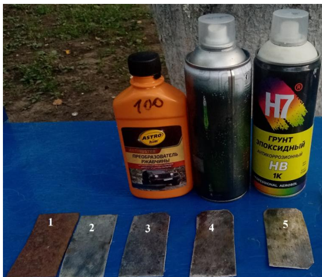
Рис. 1. Общий вид образцов для проведения исследований: 1 - образец без обработки; 2 – механически обработанный образец; 3 – образец под покрытие преобразователем ржавчины и эмалью; 4- образец под покрытие эмалью; 5- образец под покрытие грунтом эпоксидным и эмалью
