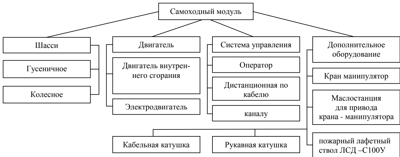
Рис. 8. Принципиальная схема модулей состава роботизированной самоходной модульной установки
